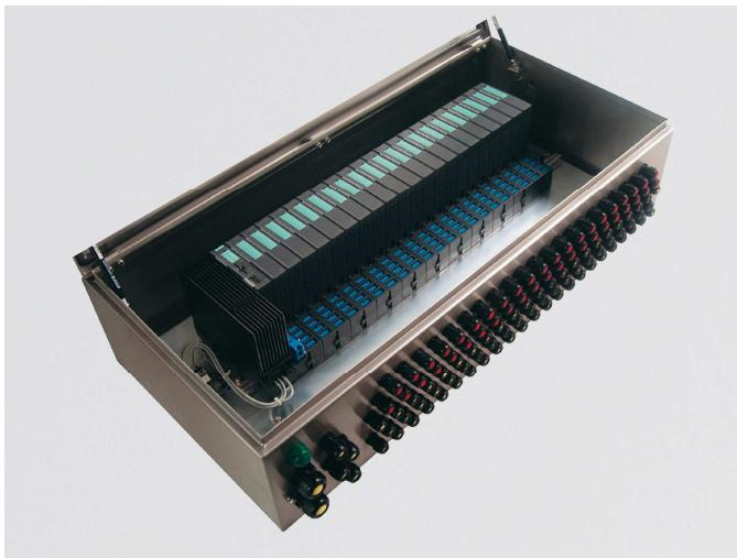
Для размещения станций ET 200iSP могут использоваться стальные шкафы настенного монтажа со степенью защиты IP65. Корпуса шкафов выполняются из высококачественной стали и имеют несколько типоразмеров для размещения станций с различным количеством модулей. Подключение внешних цепей выполняется через уплотнительные сальники M16.
