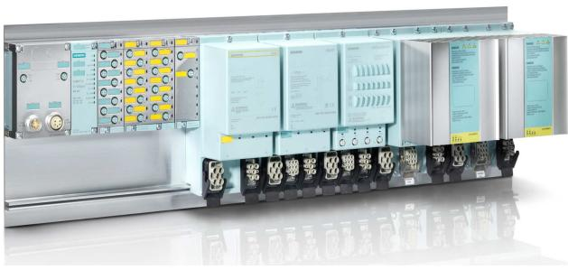
Шинные соединители интерфейсных модулей содержат начальные участки внутренней шины станции, шины питания электроники и датчиков 1L+, шины питания нагрузки 2L+. Шины питания 1L+ и 2L+ защищены сменными предохранителями.
